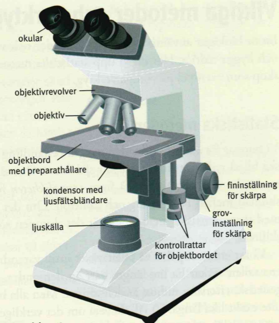
Viktiga delar på ett ljusmikroskop.
